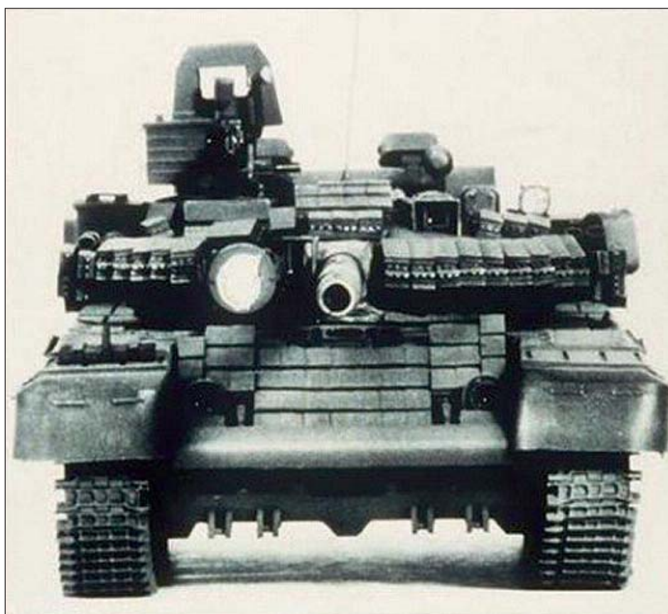
Char de bataille T 80 muni de briques réactives de protection contre les armes anti-chars
