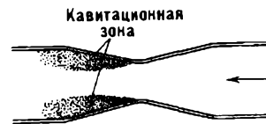
Кавитационная зона в трубке с местным сужением
