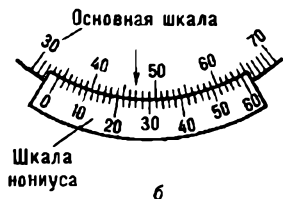
Нониусы: а – линейный (отсчёт 17,14 мм); б – угломерный (отсчёт 34°26'). Стрелки направлены на совпадающие штрихи
