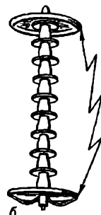
Искровой промежуток: а – стержневой; б – кольцевой (электроды 1 и 2 включены параллельно защищающей изоляции, и изолятор не подвергается воздействию электрической дуги, т.к. она горит в воздушном промежутке l , который меньше l_1 )
