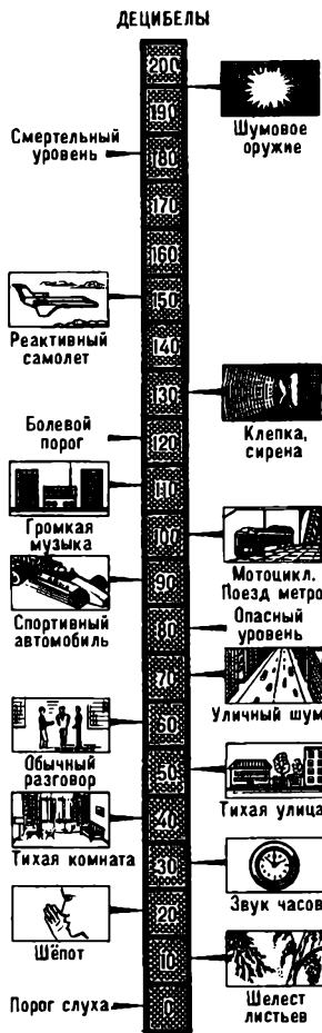
Шкала громкости звука (нулевой уровень громкости соответствует звуковому давлению 20 мкПа и интенсивности звука 10^{-12} Вт/м 2 )
