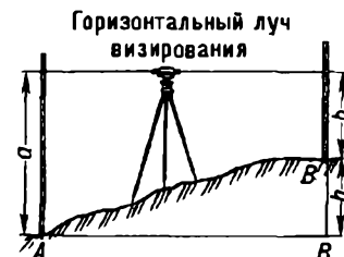
Схема геометрического нивелирования: превышение точки В (передней) над точкой А (задней) вычисляется по формуле h = a - b , где a , b – соответственно отсчёты по задней и передней рейкам
