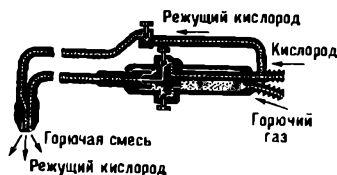
Резак для кислородной резки
