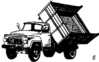
Автомобиль-самосвал с разгрузкой назад (а) и с разгрузкой вбок (б)
